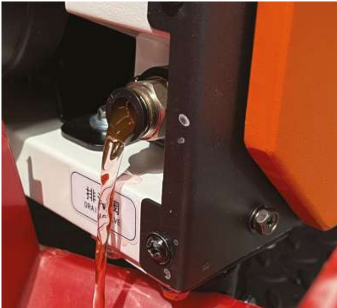
Фото 9.0.4. Слив охлаждающей жидкости.
