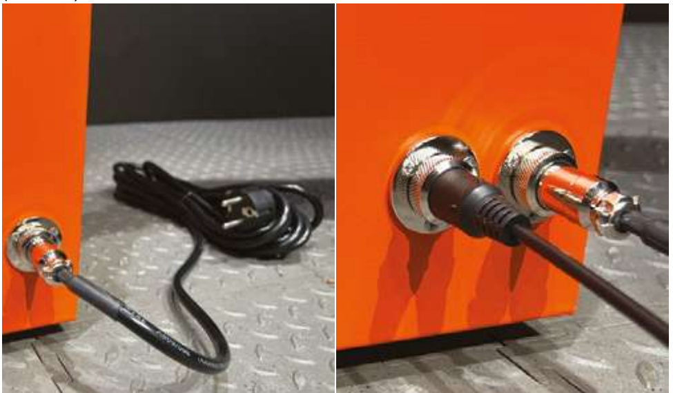
Фото 9.0.7. Подключение кабеля питания и связи.
