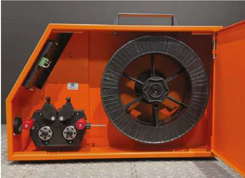
Фото 9.0.6. Установка катушки 20 кг.
