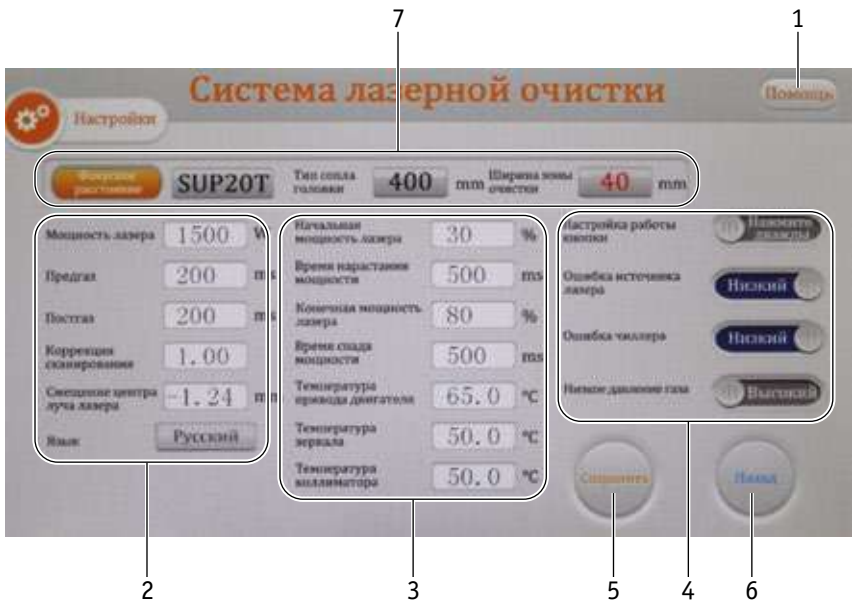
Фото 14.0.6. Главные настройки источника с фокусирующей линзой F400.
