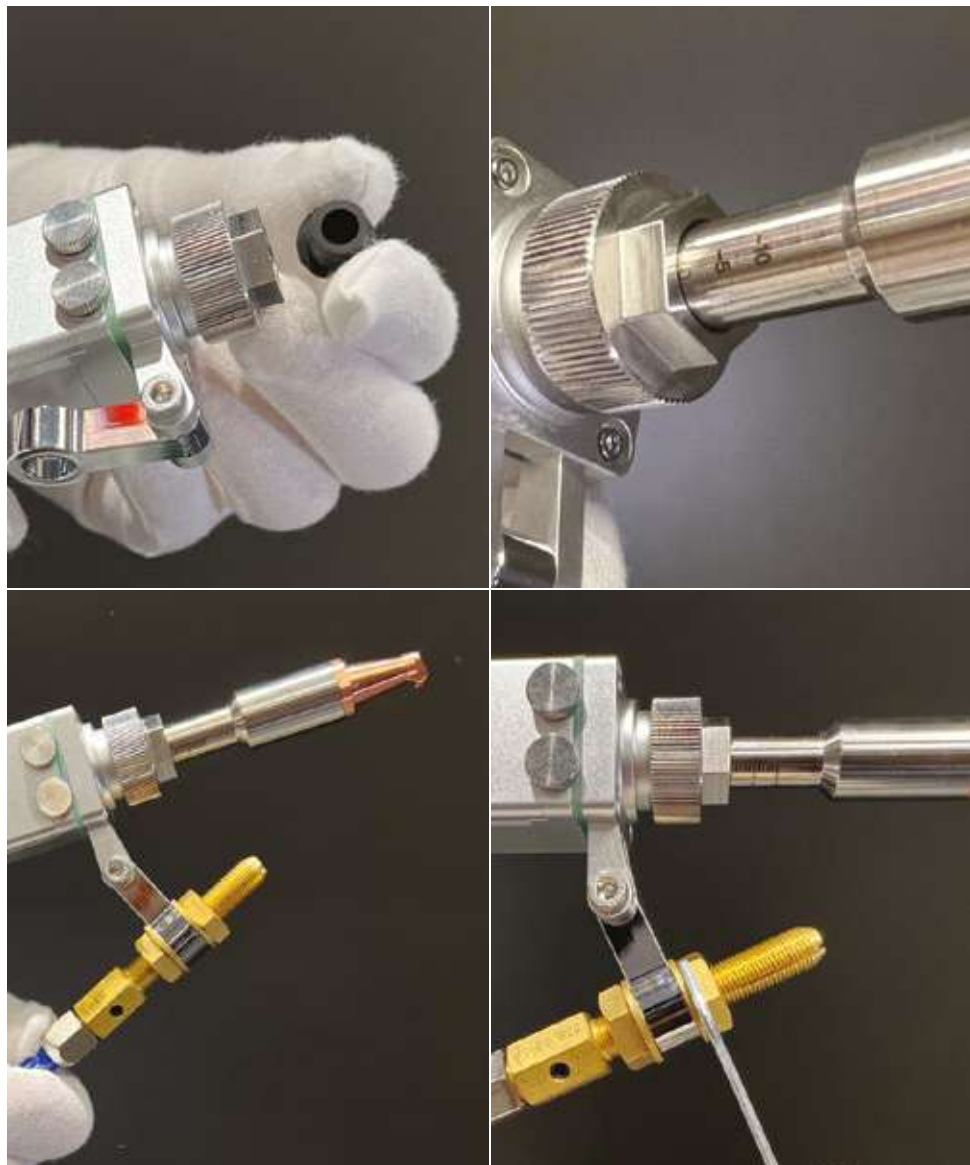
Фото 9.0.11. Сборка сварочной головки.
