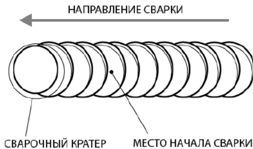
Рис. 11.1.2. Начало сварки при смене электрода.
