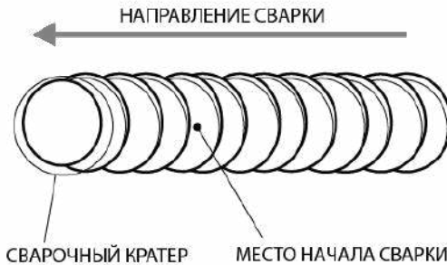
Рис. 11.2.2. Начало сварки при смене электрода.
