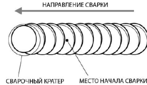
Рис. 8.1.2. Начало сварки при смене электрода.
