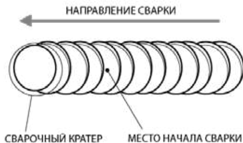
Рис. 11.2.2. Начало сварки при смене электрода.
