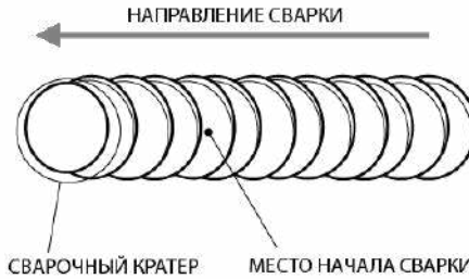
Рис.8.1.2. Начало сварки при смене электрода.
