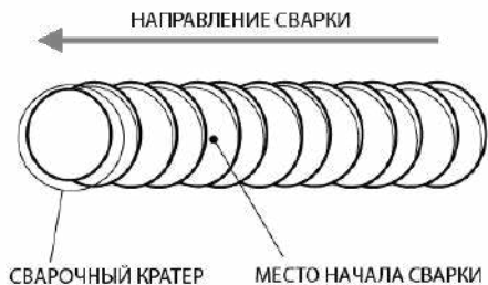
Рис. 11.2.2. Начало сварки при смене электрода.
