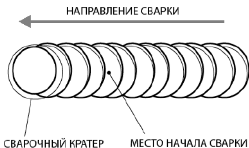
Рис. 11.1.2. Начало сварки при смене электрода.
