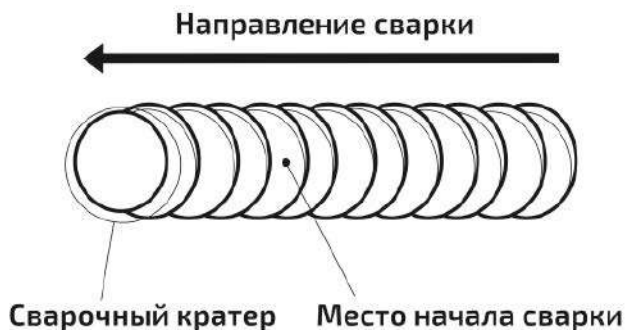
Рис. 8.1.2. Начало сварки при смене электрода.
