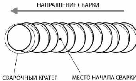
Рис. 11.2.2. Начало сварки при смене электрода.
