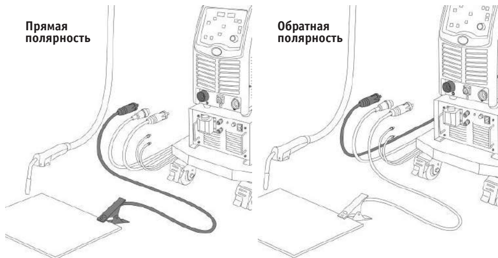
Рис. 9.1.1. Выбор полярности при MIG/MAG и FCAW сварке.
