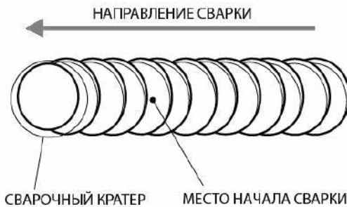
Рис. 11.2.2. Начало сварки при смене электрода.
