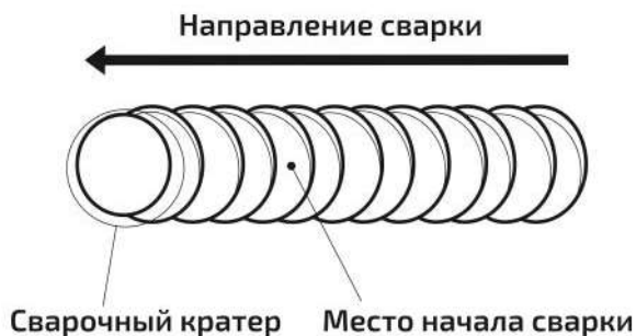
Рис. 12.4. Начало сварки при смене электрода.
