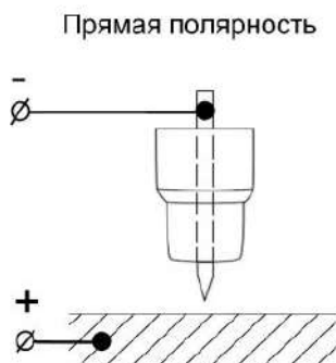
Рис. 9.2.1. Полярность при TIG сварке.
