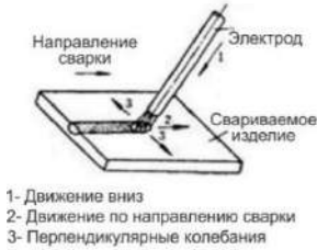
Рисунок 13.4 Три основных направления движения электрода
