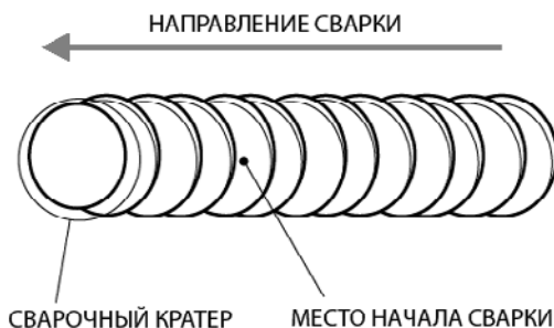
Рис. 11.4. Начало сварки при смене электрода.
