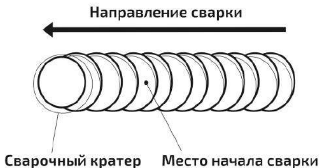
Рис. 11.1.2. Начало сварки при смене электрода.
