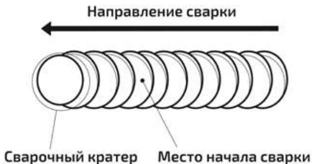
Рис. 8.1.2. Начало сварки при смене электрода.
