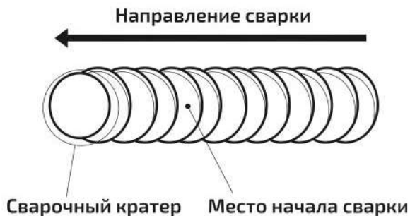
Рис. 9.1.2. Начало сварки при смене электрода.
